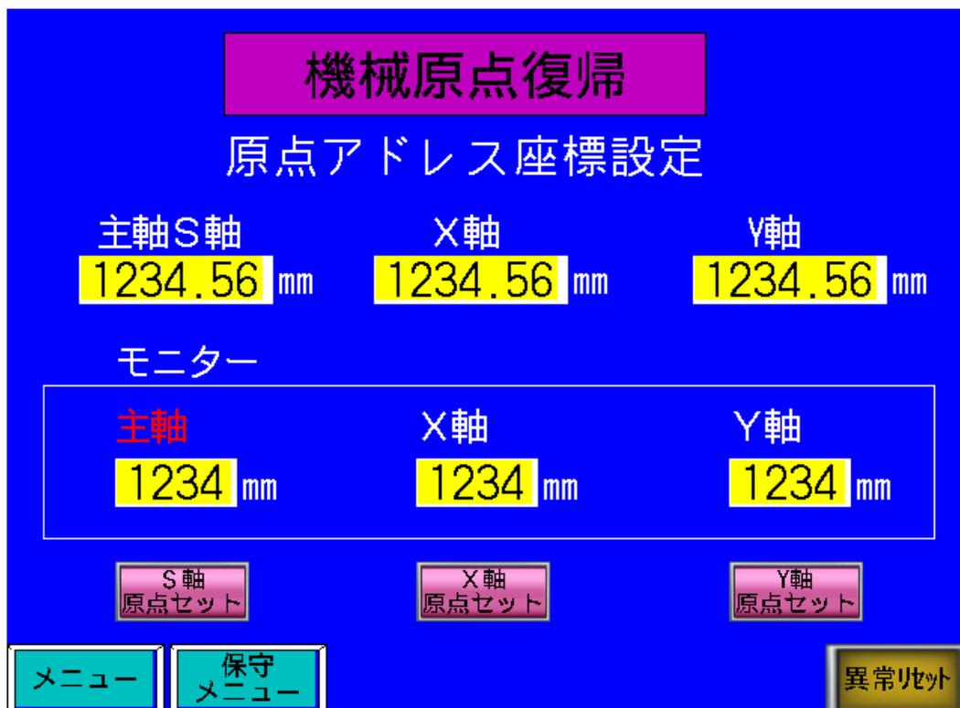
主軸(S軸)、走行(X軸)、トーチ高さ(Y軸)を原点位置に移動させて原点セットします。各軸の原点座標はゼロ以外に設定しないで下さい。動作異常を起こす可能性があります。装置を移設したりした際に設定動作を行って下さい。通常では不要です。
